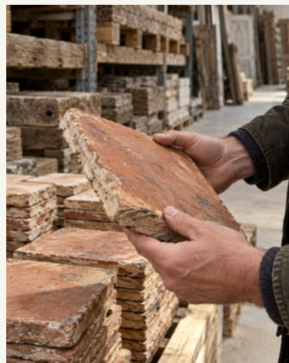
Geste 1 • deux à trois centimètres d'épaisseur, aucune fissure traversante.
